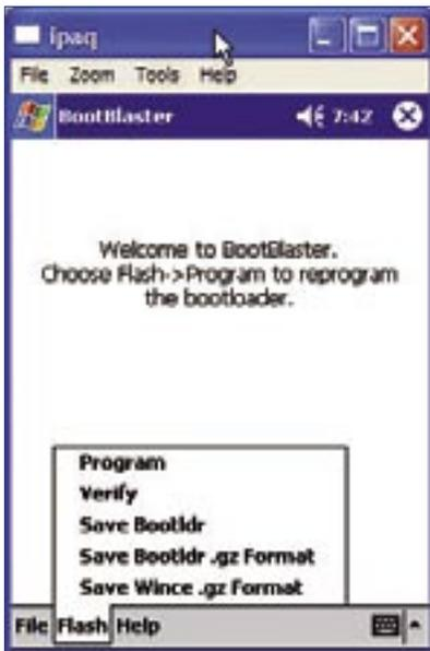
**Figura 3** Execute o *BootBlaster.exe* dentro de seu iPAQ para executar o backup da imagem e o boot do aparelho.
