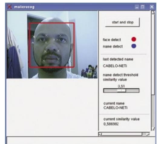
**Figura 2** Projeto Malic em ação marcando os pontos importantes para a identificação facial.
